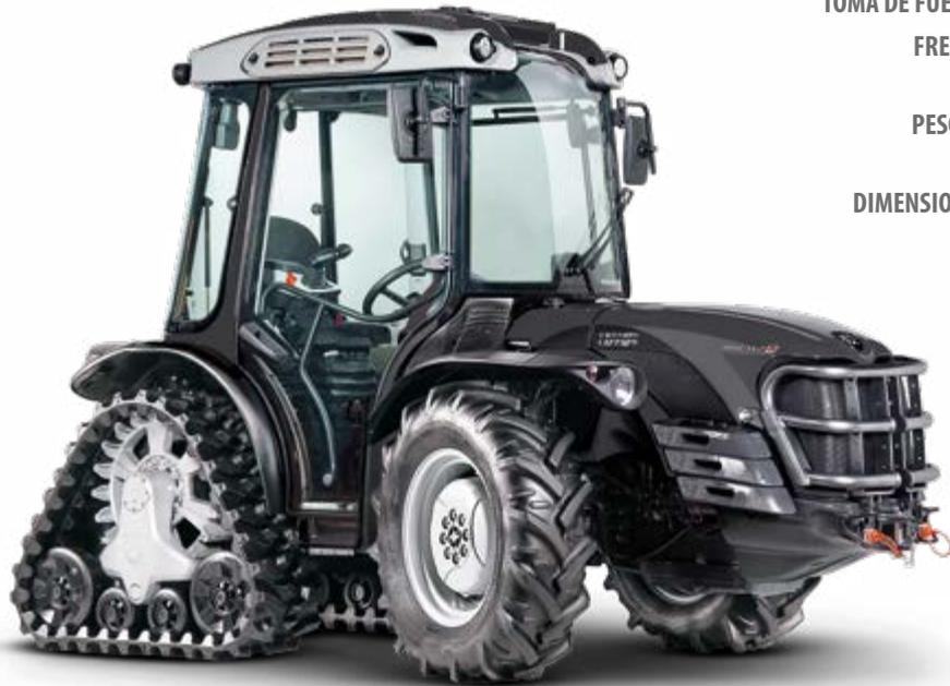
**BASTIDOR** Integral oscilante ACTIO™ • Rígido • Reversible RGS™ • Cadenados con 2 cadenas posteriores y 2 ruedas motrices delanteras
