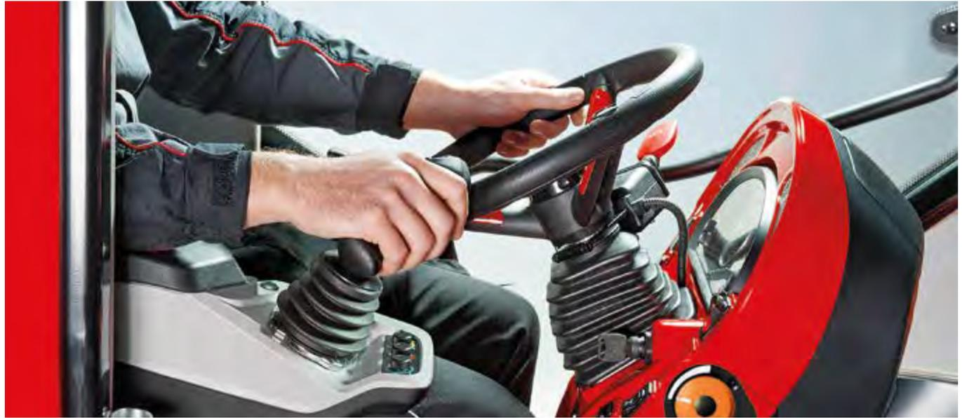
El joystick proporcional JMC™, disponible como opción, está diseñado con los criterios más innovadores para asegurar un control práctico y ergonómico del elevador y de las tomas hidráulicas traseras y delanteras. Permite regular el flujo de aceite hacia las tomas hidráulicas y al elevador de modo proporcional, garantizando un control absoluto de la velocidad y el movimiento durante la subida y bajada del apero. Todo ello, en beneficio de la precisión de trabajo.
