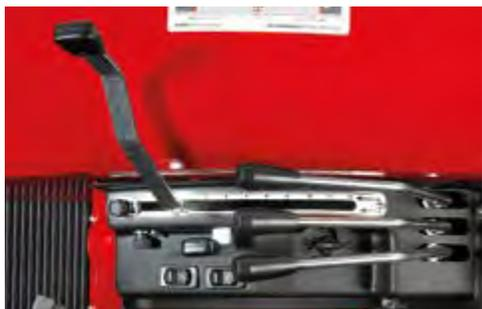
**ELEVADOR CON CONTROL DE POSICIÓN Y ESFUERZO**
