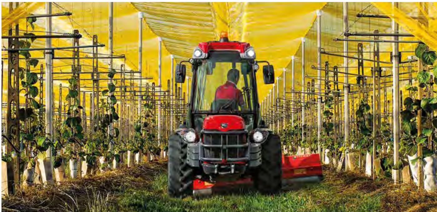
Los faros, integrados en los guardabarros, están dotados de grupos ópticos con parábola reflectante que iluminan en profundidad el espacio frontal, el apero y el campo circundante. Las operaciones de mantenimiento son rápidas y sencillas gracias a la apertura total del capó y a la fácil extracción de los laterales y de la tapa de la batería.
