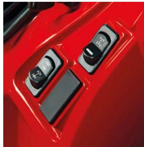
El bloqueo trasero de diferencias evita patinajes y optimiza la tracción. La desconexión de la tracción delantera es útil en la circulación por carretera y evita daños al suelo en céspedes delicados.
