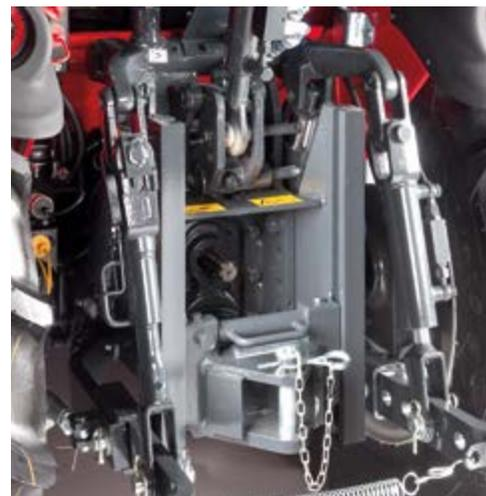
Con gancho de remolque slider\* de ajuste vertical rápido para optimizar la altura de enganche del implemento arrastrado.
