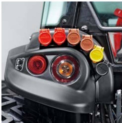
Sistema hidráulico con 3 distribuidores: 1 de doble efecto, 1 de doble efecto con posición flotante y palanca de cierre, 1 de simple efecto + toma de retorno de aceite. Total: 6 enchufes rápidos traseros.
