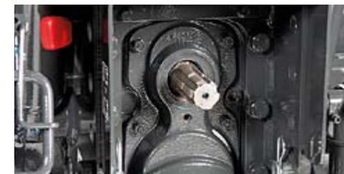
T. de F. de dos velocidades: 540/540E r/min de serie, 540/540S r/min\*, 540/1000 r/min\* sincronizada con todas las velocidades del cambio. El eje de la T. de F. es de tipo ASAE 1" 3/8 y único para todas las velocidades.
