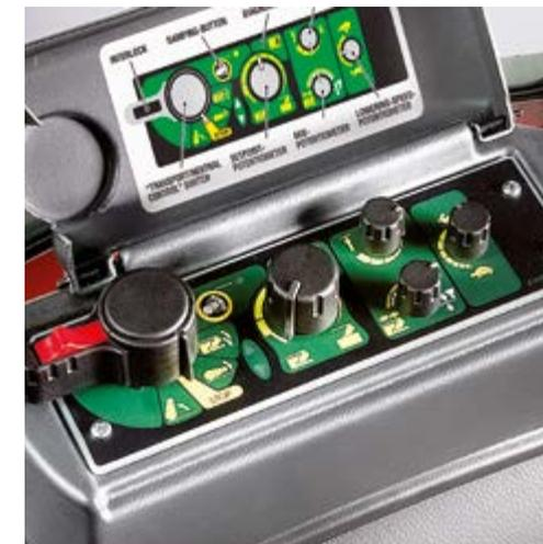
El elevador electrónico tiene una función hidráulica que hace de "damper" (amortiguador), suavizando todos los "rebotes" del tractor con el apero enganchado.
