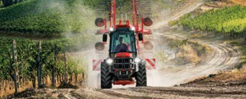
Caudal hidráulico a los distribuidores de hasta 51 l/min (opc.); permite gestionar los equipos más exigentes sin emplear unidades hidráulicas suplementarias accionadas por la TDF o joysticks para controlarlas. Se pueden integrar hasta 4 distribuidores de doble efecto y un total de 12 tomas hidráulicas traseras y 6 delanteros (N.B. en la versión especial con Joystick proporcional).
